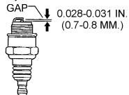
Figure 18. Spark Plug Gap
